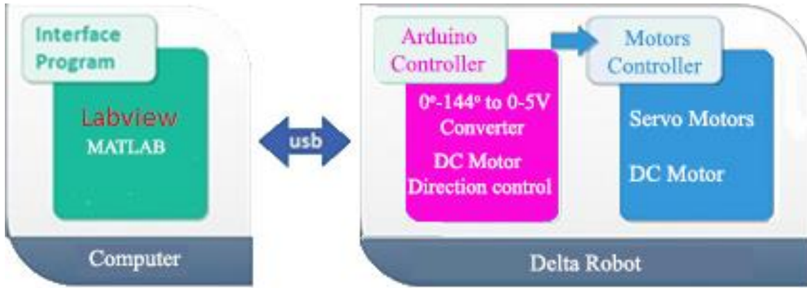
Şekil 3. Tasarlanan delta robotun genel blok diyagramı
